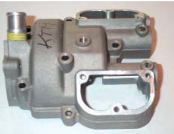
Bild 2. Dichtung an einem Kühlwasseranschluss
