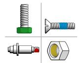
Es existiert eine Vielzahl von klemmenden Gewindesicherungssystemen. Fast alle Produkte entsprechen den Anforderungen der DIN 267, Teil 28. Die Produkte unterscheiden sich optisch durch ihre Farben. Je nach Einsatzzweck bieten die Produkte zudem Unterschiede in den Temperaturbereichen und Funktionen.
